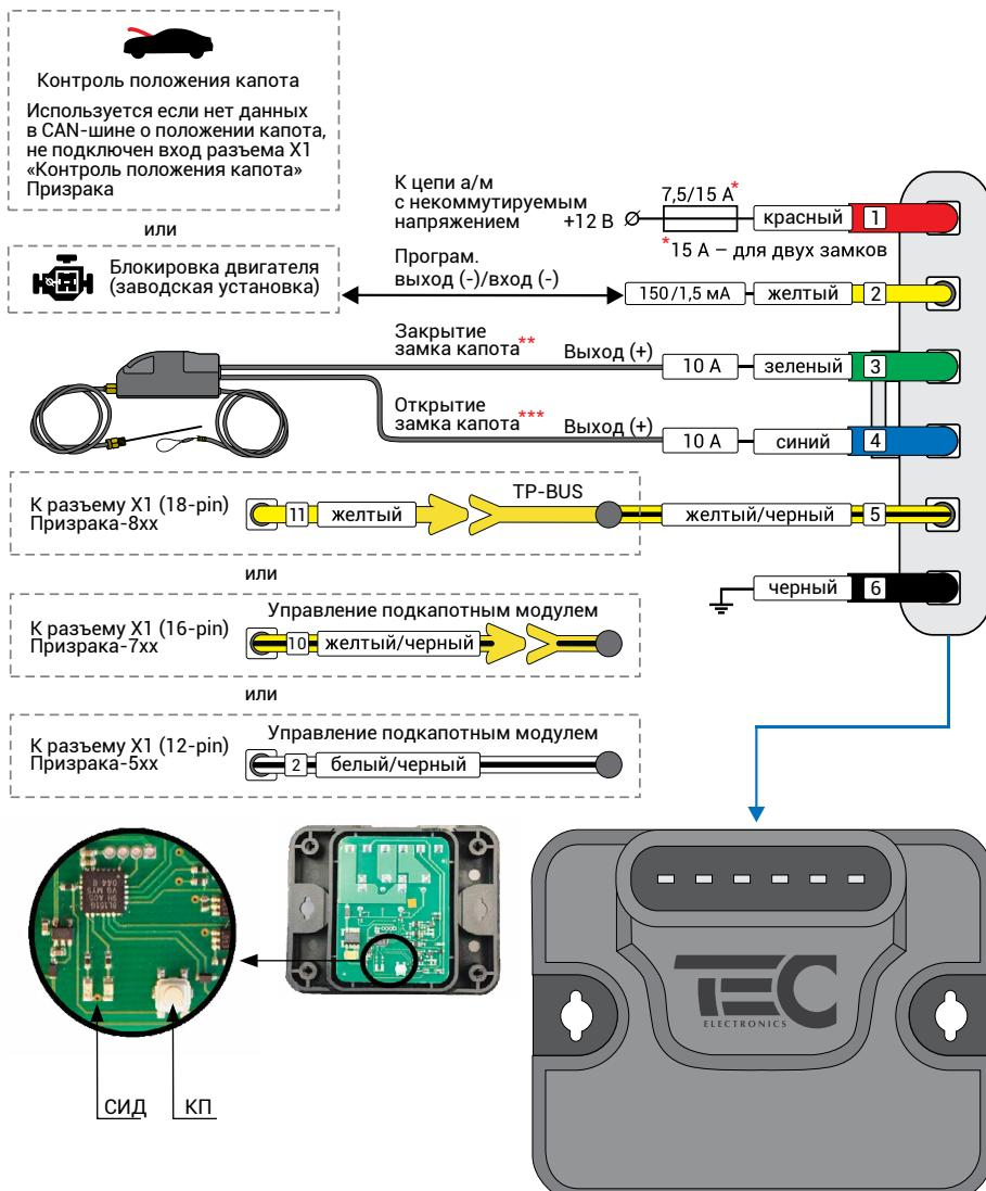
\*\* Формируется импульс длительностью 0,8 с после постановки а/м на охрану (запирания ЦЗ) и при срабатывании блокировки.
